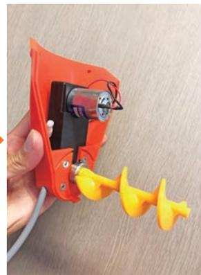
洗浄型単頭制限ホッパーNK13-04Wと同様の仕組みを採用し、ロックピンを2本外すだけで簡単に水洗することができます。万が一の故障時や消耗品交換時、念入りに洗いたい場合には、切出機前面にあるネジを2本外すだけで、切出機を簡単に分解することができます。
