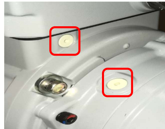
対象品:モーターリード線の通し穴跡にブッシュが圧入されている
